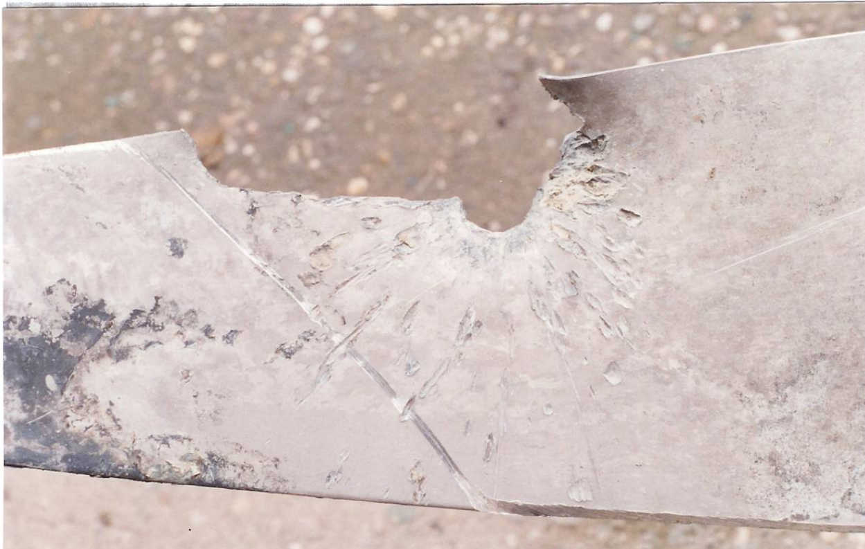
Een detailopname van de propeller van Roos' toestel; Inslag van een 20 mm granaat
